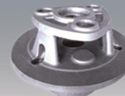
行星架 Planet carrier 2500Kg, EN-GJS-500-7U
